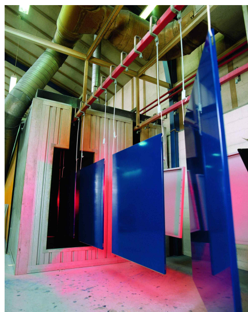
Pulverlakeringen foretages i eget anlæg med farver efter RAL-skalaen.
